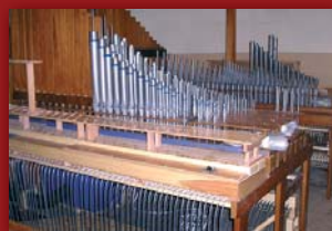
Wiatrownice nowych organów, pierwsze wstawione chóry głosów
