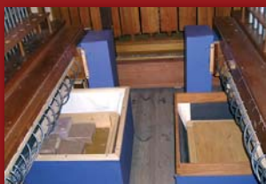
Michy: z lewej pomocnicze, prawej główne z widoczną w tyle dmuchawą
